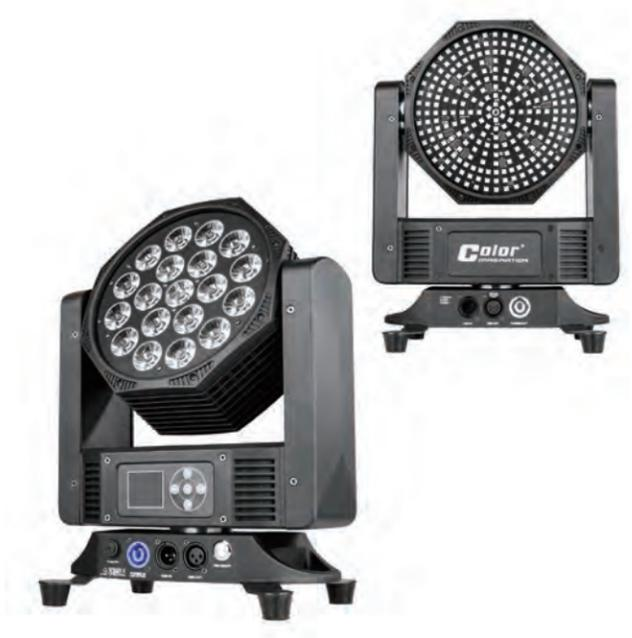
SMARTFACE 1910C是一款大功率的双面设计智能摇头染色/频闪灯,设计紧凑新颖,重量轻。一面使用19颗10W四合一LED灯珠(RGBW),灯珠分3圈可单独控制,设计有2800K-5600K的色温调节功能。另一面使用246颗0.2W三合一5050 LED灯珠(RGB),灯珠分9圈可单独控制,设计有2800K-5600K的色温调节功能。产品不仅仅可作为摇头染色用(摇头面光),也可作为效果出众的摇头频闪灯。
