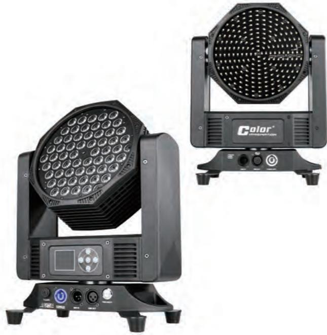
SMARTFACE 603T是一款大功率的双面设计智能摇头染色/频闪灯,设计紧凑新颖,重量轻。一面使用60颗3W三合一LED灯珠(RGB),灯珠分6个区块可单独控制,设计有2800K-5600K的色温调节功能。另一面使用220颗0.2W二合一LED灯珠(正白+暖白),灯珠分10圈可单独控制,设计有2500K-4600K的色温调节功能。产品不仅可作为摇头染色用(摇头面光),也可作为效果出众的摇头频闪灯。
