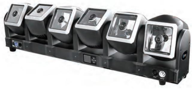
C66是一款全新的高性能舞台用摇头长条光束灯，产品设计有6个单独可控的迷你灯头，每个灯头使用一颗60W四合一LED灯珠。得益于产品设计的多功能性及优越的特征，特别是光学系统的独特性（3.5°光束角度），产品可带给用户前所未有的动态式锐利径直的光束效果，舞台呈现效果极佳，观众体验感超强。同时，由于每个灯头前部设计有灯条效果，可带给观众炫目绚丽的灯光效果。
